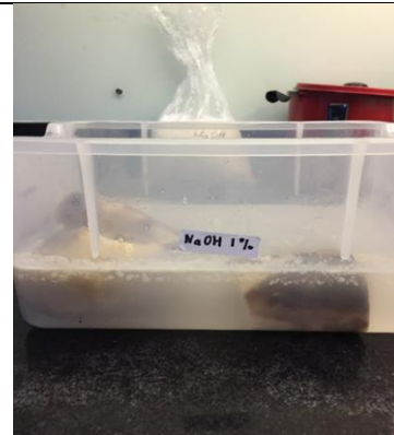
Proses Perendaman Tulang Sapi dalam NaOH 1%
