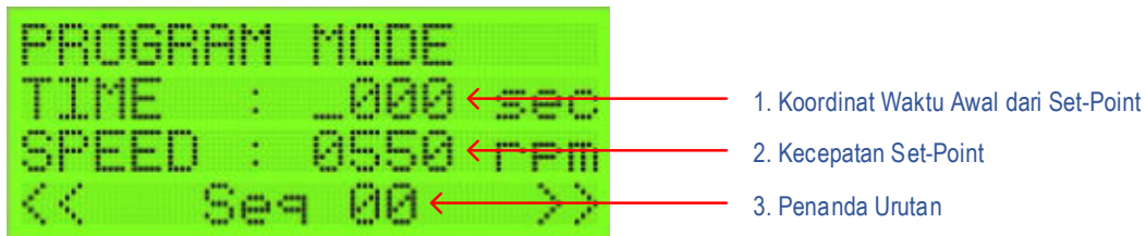
Gambar 5.14 Tampilan LCD perangkat pada posisi Program Mode dan keterangannya. Sumber: Rancangan Penelitian.
