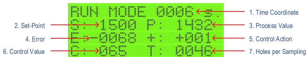
Gambar 5.18 Tampilan LCD perangkat pada posisi Run Mode dan keterangannya.
