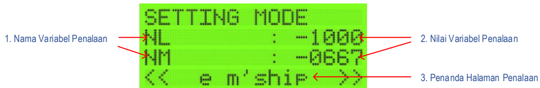
Gambar 5.16 Tampilan LCD perangkat pada posisi Setting Mode dan keterangannya.
