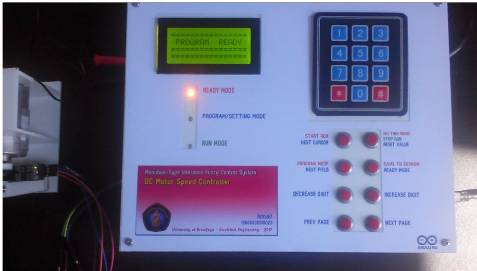
Gambar 5.8 Perangkat keras pengendali dalam posisi Ready Mode .
