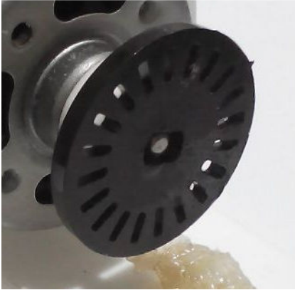
Gambar 5.3 Optical Chopper 20 lubang pada poros motor DC.
