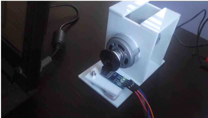
Gambar 5.9 Perangkat motor DC dan speed sensor .
