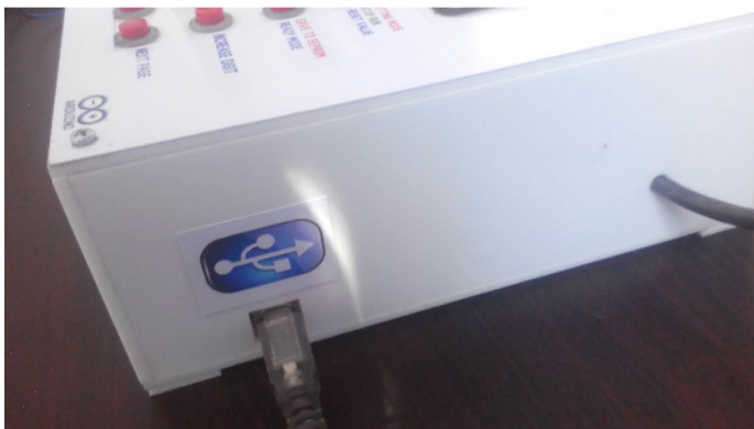
Gambar 5.10 USB port pada perangkat pengendali.
