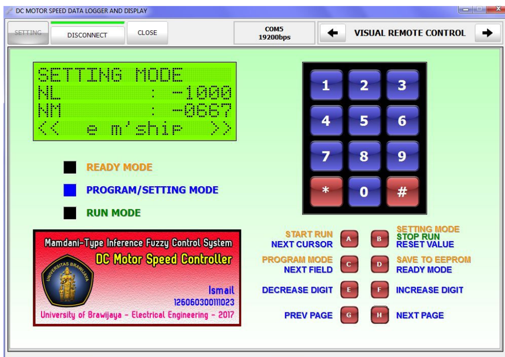
Gambar 5.24 Perangkat memasuki Setting Mode dilihat dari Data Logger .
