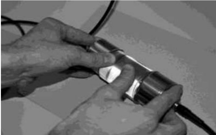
Gambar 3.3 Proses kalibrasi awal alat uji UPV
