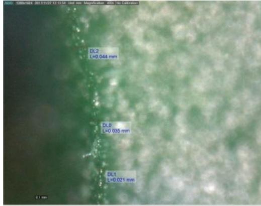
Gambar 4.2. Pengukuran ketebalan lapisan TiO<sub>2</sub> dengan pembesaran 400x
