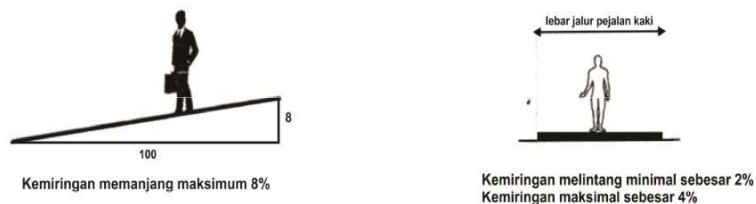
Gambar 2.4 Kemiringan Jalur Pejalan Kaki Sumber : Permen PU (2014)
