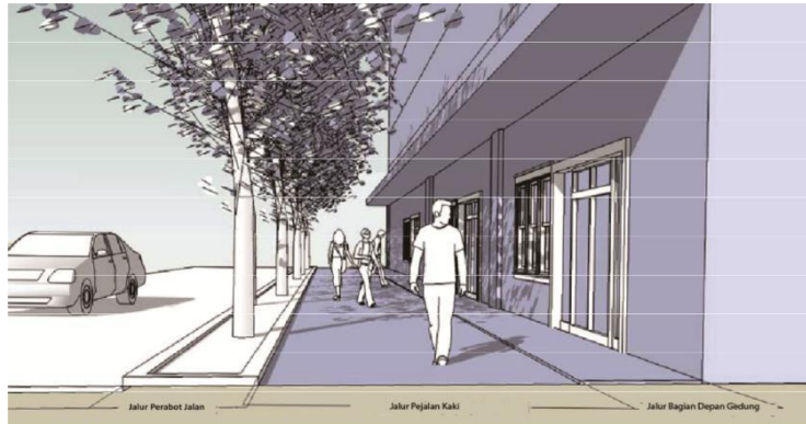
Gambar 2.9 Jalur pada Ruas Pejalan Kaki Sumber : Permen PU (2014)
