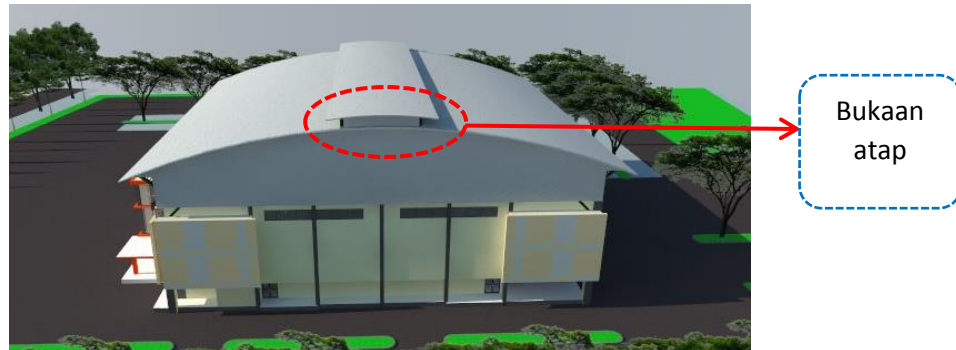
Gambar 4.44 Bukaan Atap Sebagai Outlet Pada Bangunan Sumber : Dokumentasi Pribadi
