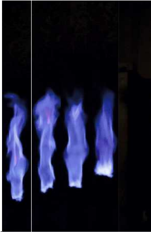
Visualisasi api pada variasi kecepatan udara (a) 0,7 m/s; (b) 1,8 m/s; (c) 2,4 m/s; (d) 3,6 m/s; (e) 5,3 m/s dengan kecepatan bahan bakar 5,31 m/s dengan swirl vanes sudut 6
