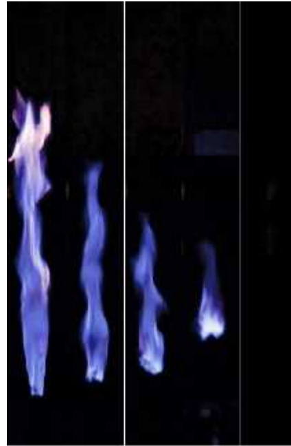
Visualisasi api pada variasi kecepatan udara (a) 0,7 m/s; (b) 1,8 m/s; (c) 2,4 m/s; (d) 3,6 ms; (e) 5,3 m/s dengan kecepatan bahan bakar 8,85 m/s tanpa pemasangan swirl
