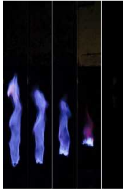
Visualisasi api pada variasi kecepatan udara (a) 0,7 m/s; (b) 1,8 m/s; (c) 2,4 m/s; (d) 3,6 m/s; (e) 5,3 m/s dengan kecepatan bahan bakar 5,31 m/s tanpa pemasangan swirl
