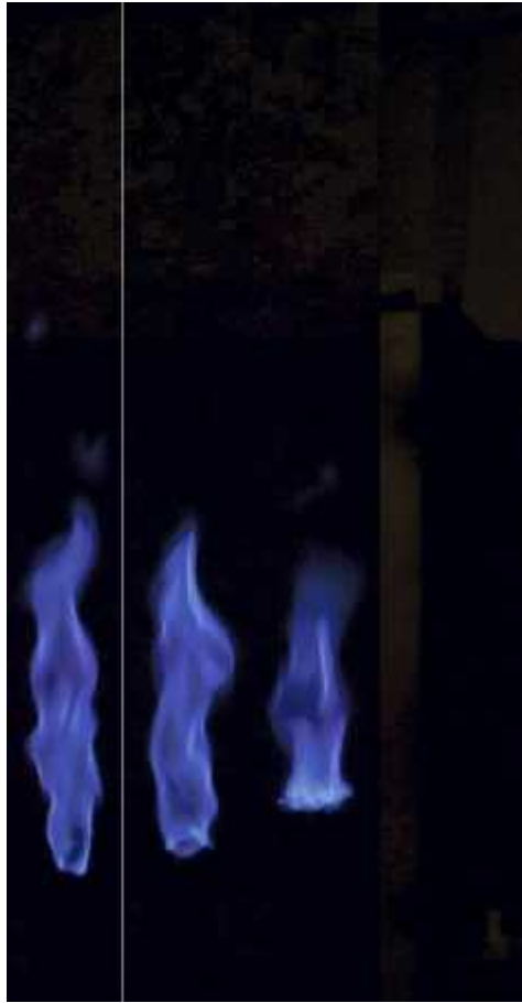
Visualisasi api pada variasi kecepatan udara (a) 0,7 m/s; (b) 1,8 m/s; (c) 2,4 m/s; (d) 3,6 m/s dengan kecepatan bahan bakar 3,54 m/s dengan swirl vanes sudut 6
