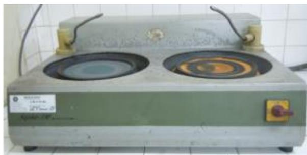
Gambar 3.4 *Centrifugal Sand Paper Machine*
