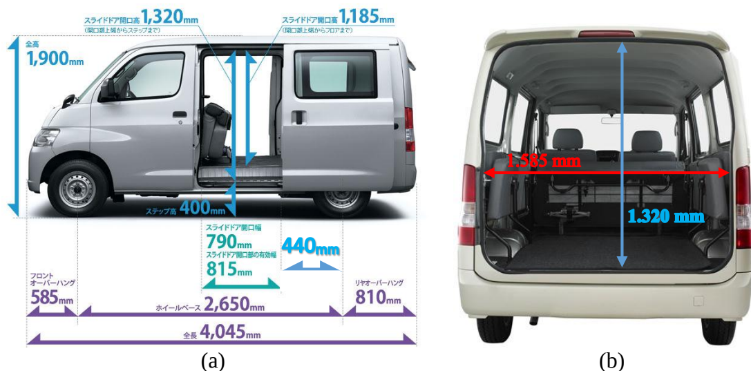
Gambar 4.6 Dimensi Mobil Granmax Minibus 1.3 (a) Tampak samping (b) Tampak belakang Sumber: modifikasi (2013)
