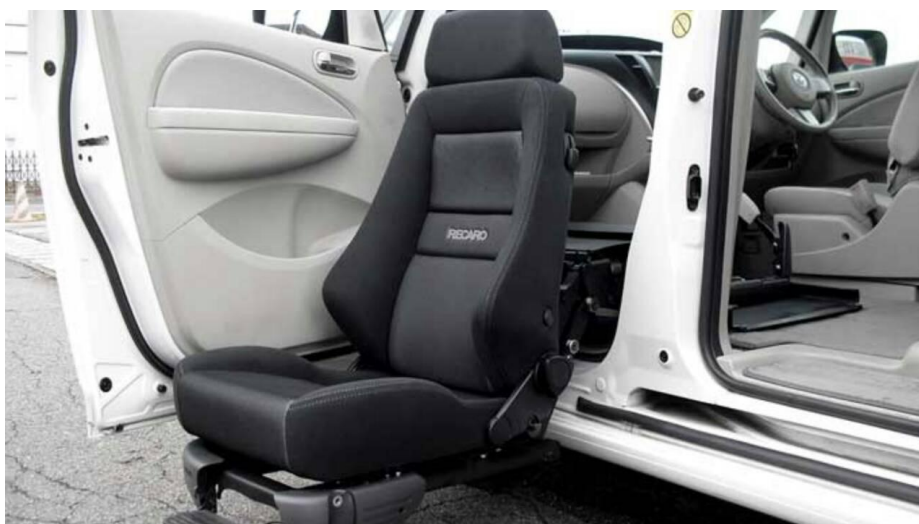
Gambar 1.2 Salah satu mobil modifikasi dengan fitur Turny Evo untuk kaum difabel dan Manula Sumber: www.hbra.co.id
