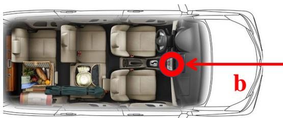
Gambar 4.8 Alarm mobil (a) dan lokasi pemasangan (b) mobil MPV dan SUV
