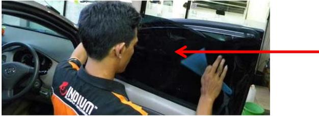
Gambar 4.9 Pemasangan kaca film mobil MPV dan SUV
