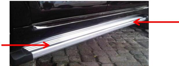
Gambar 4.4 Pinjakan samping mobil MPV dan SUV
