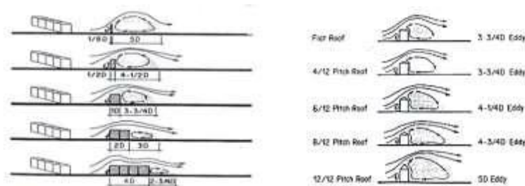
Gambar 2.4 Pengaruh dimensi dan bentuk bangunan terhadap ukuran bayangan angin. Sumber: Boutet, 1987
