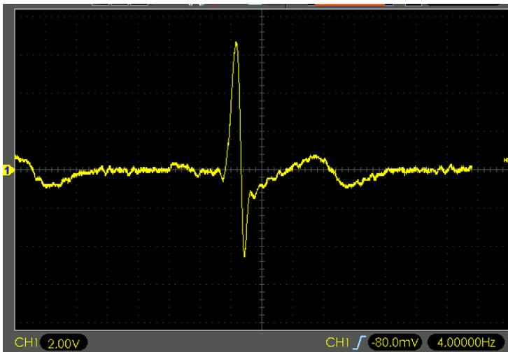
Gambar 3. 8 Hasil pengukuran gelombang ECG
