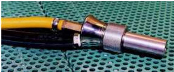
Gambar 3.2 Kepala Injektor untuk Injeksi Sandblasting Kabin Elch 130
