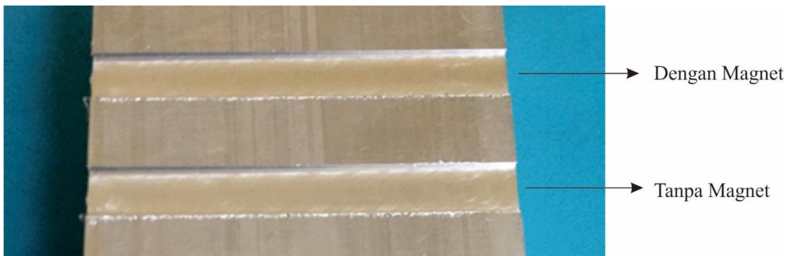
Gambar Benda Kerja Hasil Proses End Milling Dengan Variasi Spindle Speed 900 rpm
