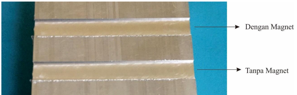
Gambar Benda Kerja Hasil Proses End Milling Dengan Variasi Spindle Speed 700 rpm
