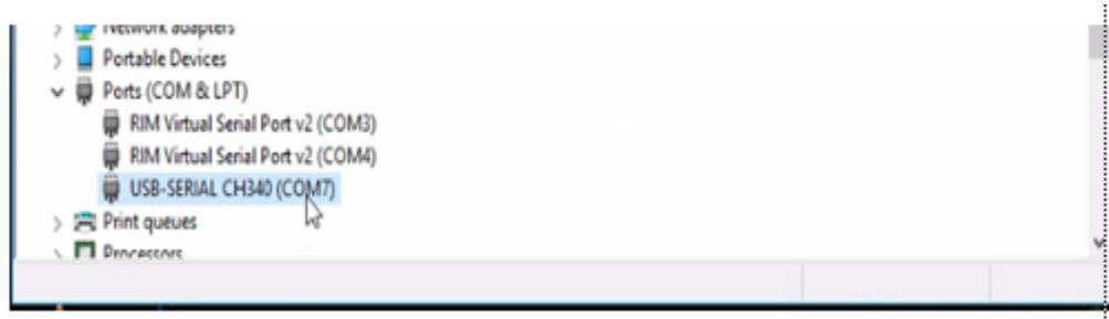
Gambar 3.8 USB-Serial CH340 (COM7) telah terinstall.
