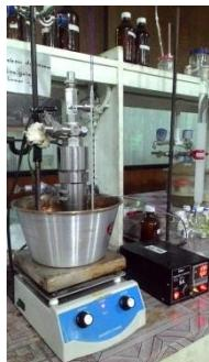
Reaksi menggunakan *stainless steel autoclave* dengan pemanas *oil bath* pada suhu 100°C selama 8 jam
