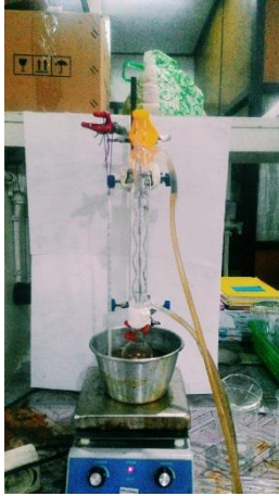
D.1 Rangkaian alat refluks
