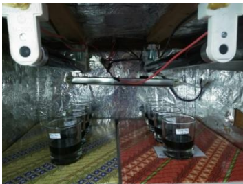
Gambar D.5 Penyinaran limbah batik menggunakan sinar UV
