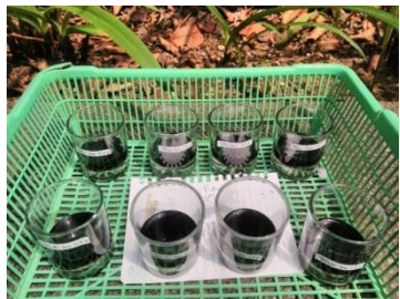
Gambar D.4 Penyinaran limbah batik menggunakan sinar matahari
