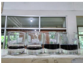
Gambar D.8 Limbah batik menguap saat penyinaran sinar matahari (kiri: matahari, kanan: UV)
