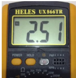
Gambar 3.18 Hasil output rangkaian zero crossing dengan multimeter
