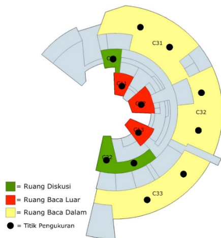
Gambar 4.35 Titik pengukuran lantai 2
