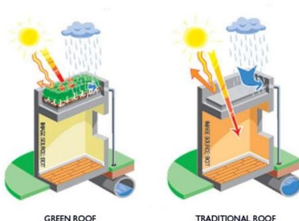
Gambar 2.7 Skematik buangan air hujan
