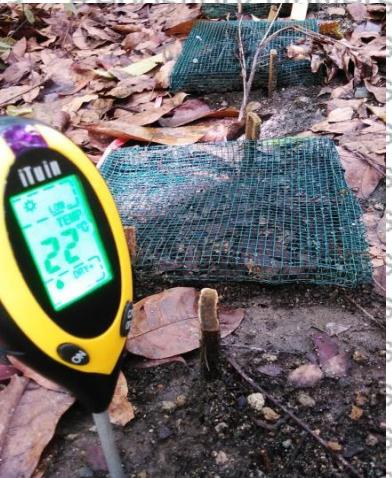
Gambar 7. Pengukuran suhu di tanah selama percobaan
