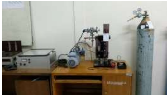
Satu set sistem plasma nitrogen
