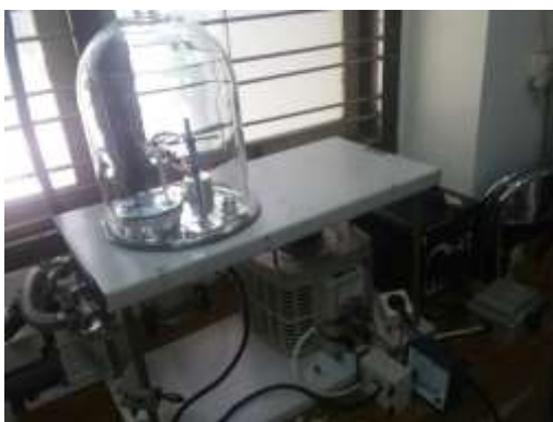
Seperangkat evaporator vakum
