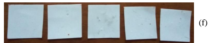
Sampel Bioplastik Pati Ubi Kayu dengan Variasi Filler ZnO Sebelum Uji Ketahanan air (a) 0% (b) 5% (c) 10% (d) 15% (e) 20% (f) 25%
