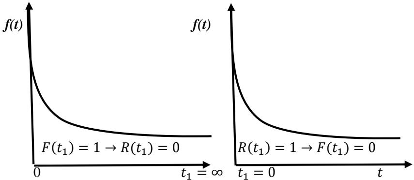
Gambar 2.2. Hubungan antara  $F(t_1)$  dan  $R(t_1)$  ketika  $t = \infty$ .
