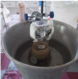
Proses sintesis dengan pengadukan menggunakan magnetic stirrer
