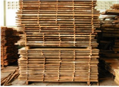
Gambar 4.11 Cara penumpukan kayu Sumber: Agus, 2010
