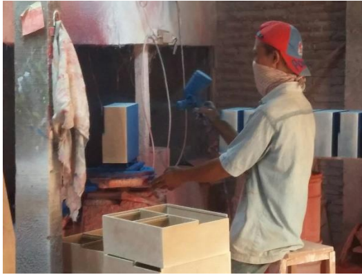
Gambar 4.6 Proses pengecatan dasar
