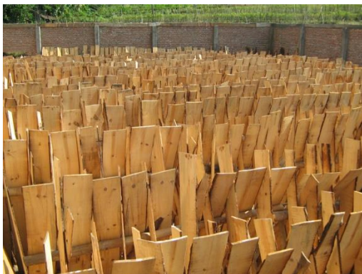
Gambar 4.2 Proses pengeringan kayu
