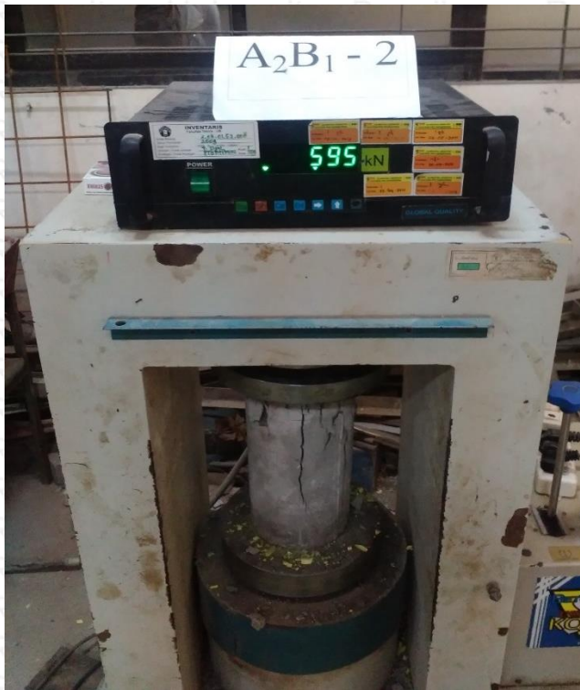
Gambar 4. 10. Pengujian Kuat Tekan Beton
