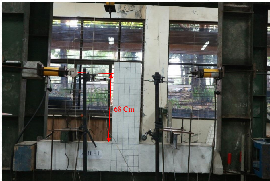
Gambar 4. 15 Pemodelan Pengujian Beban Lateral Satu Arah
