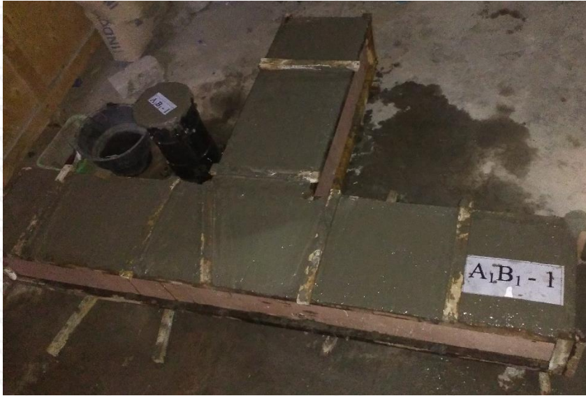
Gambar 4. 8. Hasil Cor Benda Uji Sambungan Balok-Kolom dan Silinder
