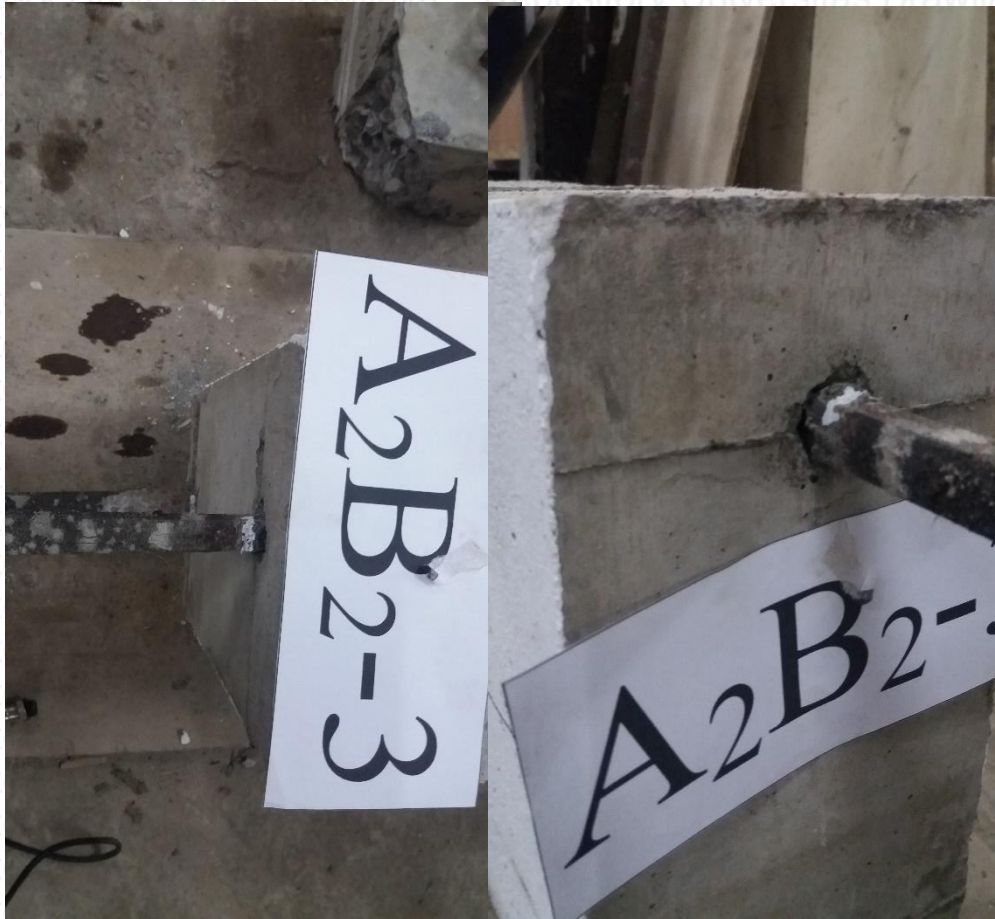
Gambar Keruntuhan Benda Uji Pull Out A_2B_2 - 3
