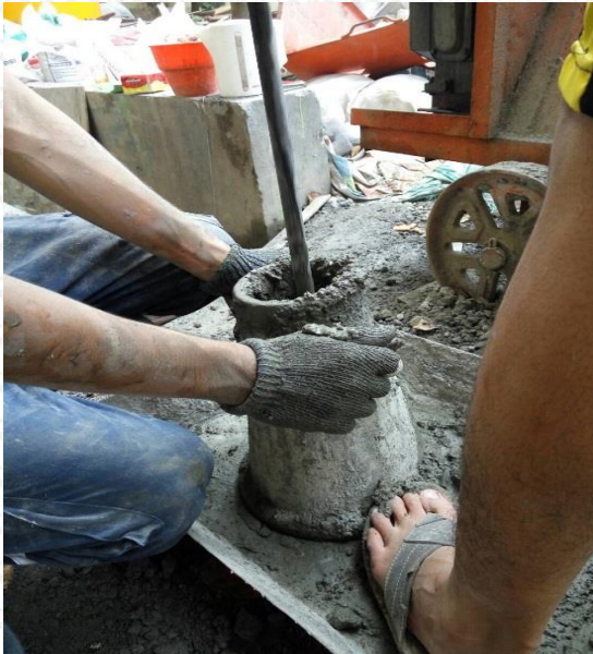
Gambar 4. 9. Pengujian Slump pada saat Pengecoran
