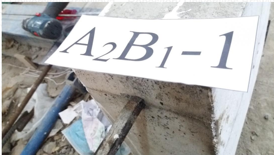
Gambar Keruntuhan Benda Uji Pull Out A 2 B 1 - 1
