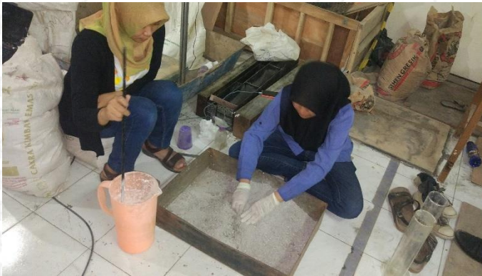
Gambar Proses Pencampuran Tanah dengan Kapur
