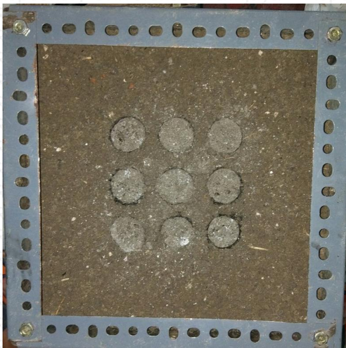
Gambar Instalasi Kolom DSM (5)
