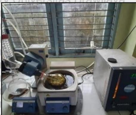
Proses evaporasi ekstrak daun teh hijau menggunakan rotary evaporator.
