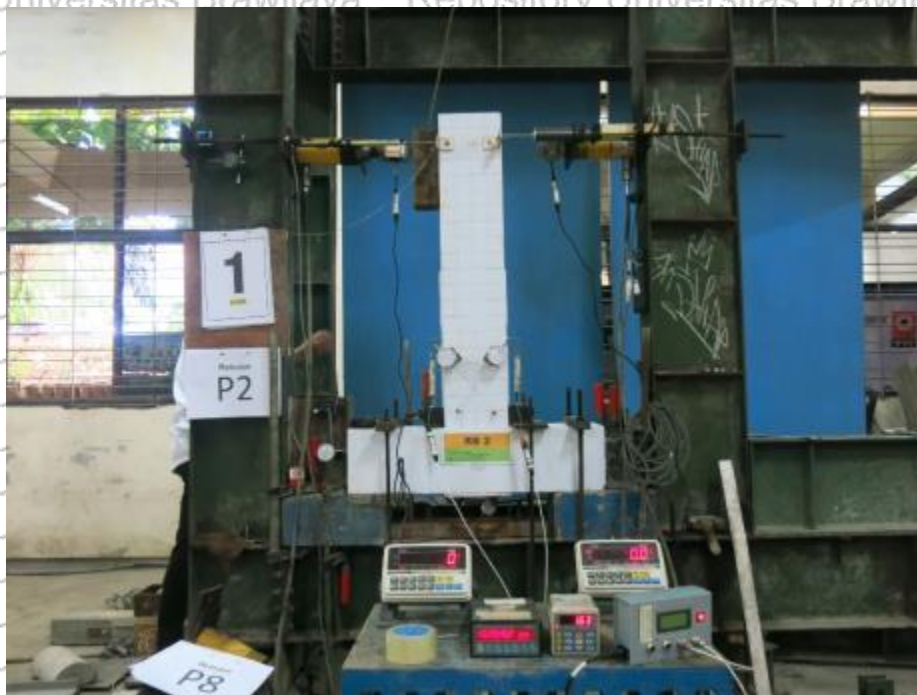
Gambar 4.11 Setting alat dan benda uji beban quasi-siklik
