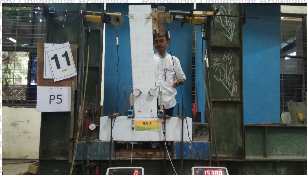
Gambar 5.16 Kondisi benda uji saat kapasitas maksimum
