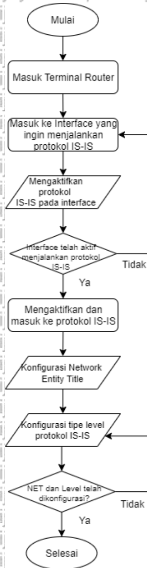
Gambar 4.7 Diagram alir konfigurasi protokol IS-IS
