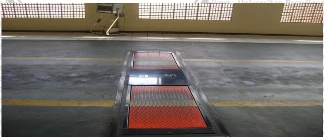
Gambar 5.4 Alat *Side Slip Tester*
