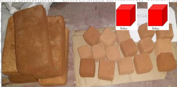
Gambar 4. 3 Benda uji kubus batu bata
