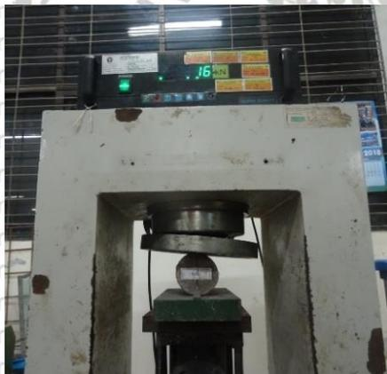
Gambar 2. 2 Pengujian kuat tarik belah mortar
