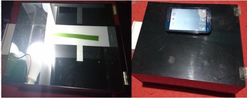
Gambar 5.2 Akuisisi Citra dalam Constant Lux Box
