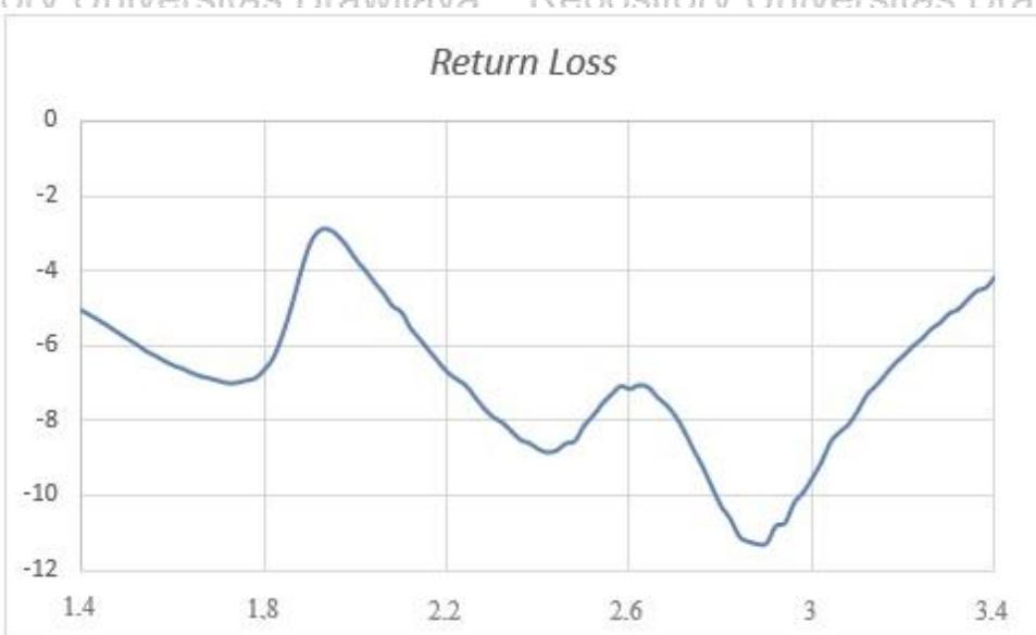
Gambar 4.85 Grafik Hasil Pengukuran *Return Loss* Antena Mikrostrip Roger Duroid RT5880 Bending 220 mm dengan *Patch* berbentuk Bintang 18
