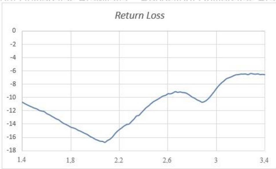
Gambar 4.86 Grafik Hasil Pengukuran *Return Loss* Antena Mikrostrip Roger Duroid RT5880 Bending 450 mm dengan *Patch* berbentuk Bintang 18
