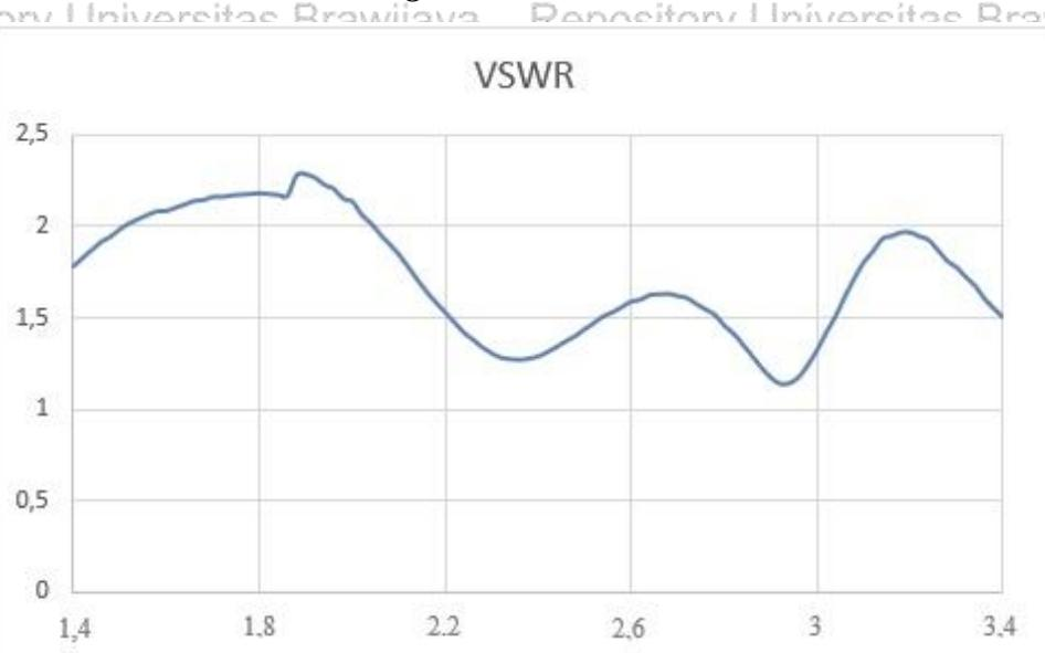
*Gambar 4.74 Grafik Hasil Pengukuran VSWR Antena Mikrostrip FR-4 Bending 450 mm dengan Patch berbentuk Bintang 18*
