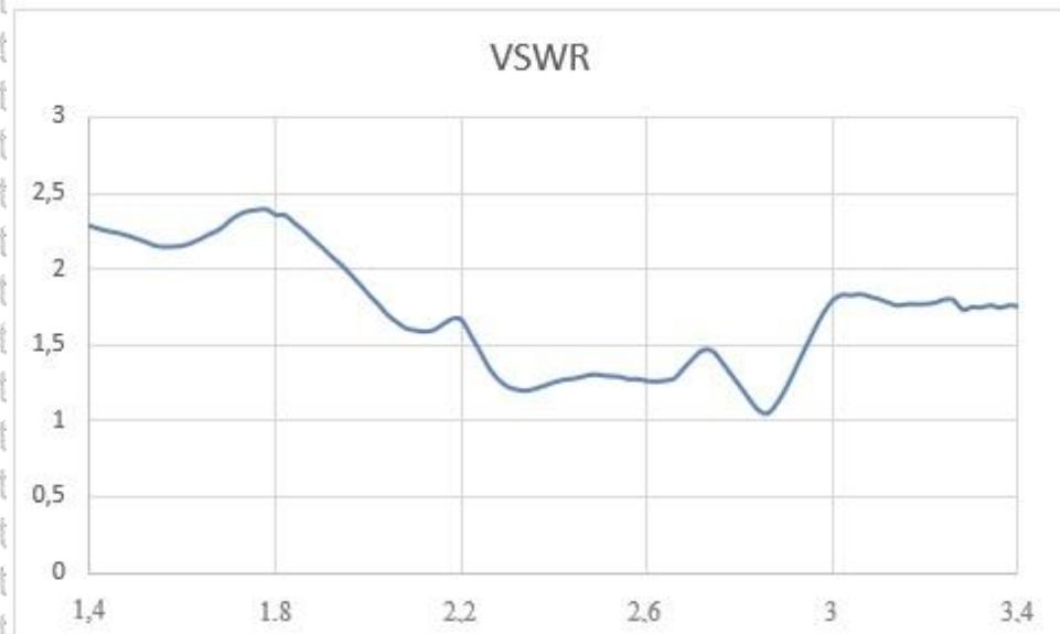
Gambar 4.80 Grafik Hasil Pengukuran VSWR Antena Mikrostrip Roger Duroid RT5880 Bending 100 mm dengan Patch berbentuk Bintang 18
