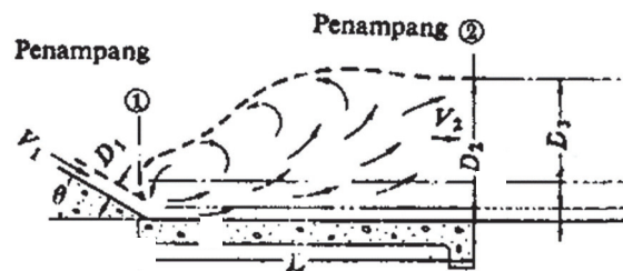
Gambar 2.2 Bentuk kolam olak datar tipe I Sumber: Sosrodarsono, 1981:217
