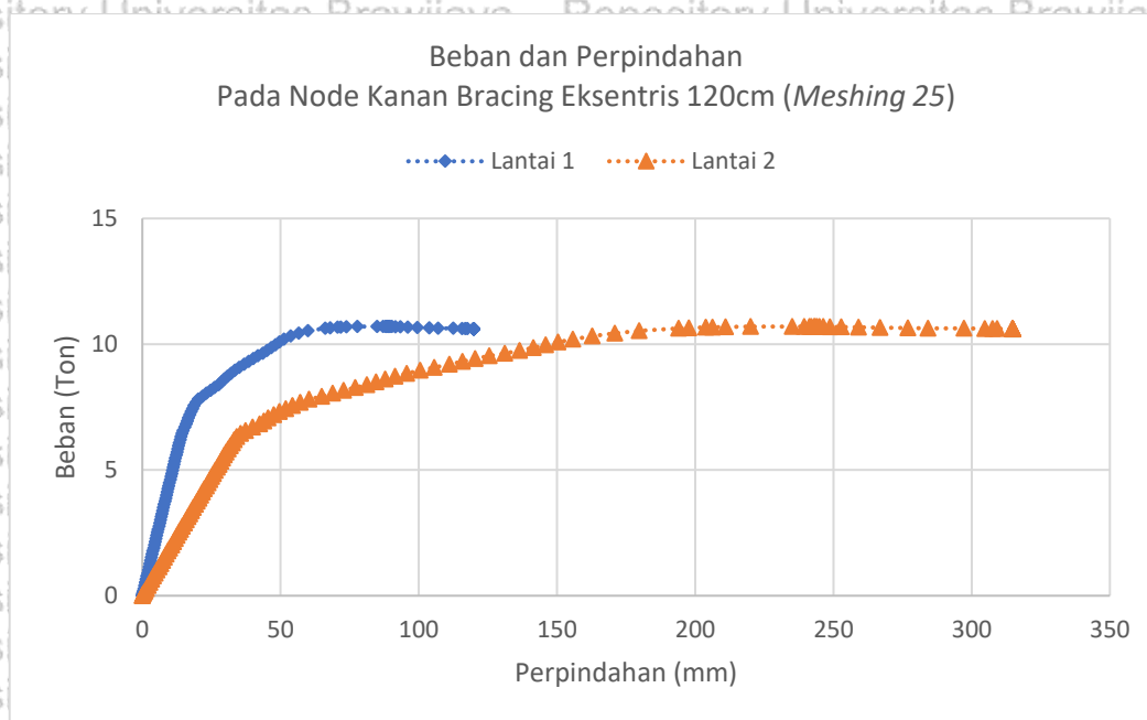
Gambar 4. 31 Hasil Pemodelan 120 cm Meshing 25 Node Kanan
