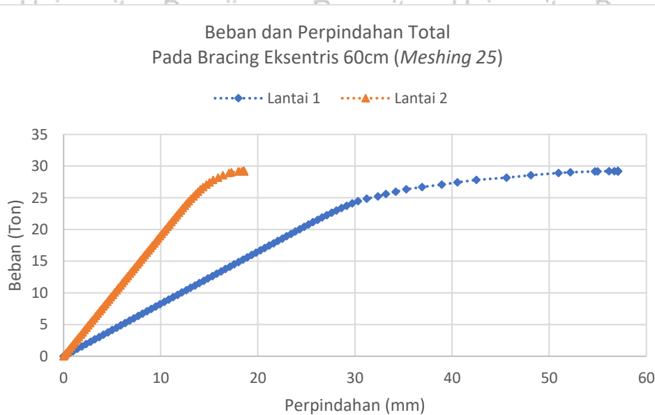
Gambar 4. 28 Hasil Pemodelan 60 cm RF Total Meshing 25
