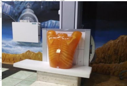
Gambar 5.12. Posisi TLD pada tengah permukaan phantom thorax
