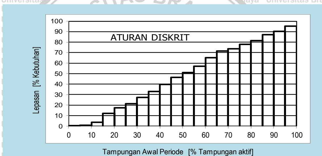
Gambar 4.9 Grafik Hasil Simulasi Aturan Lepasan Berdasarkan Tampungan Embung
