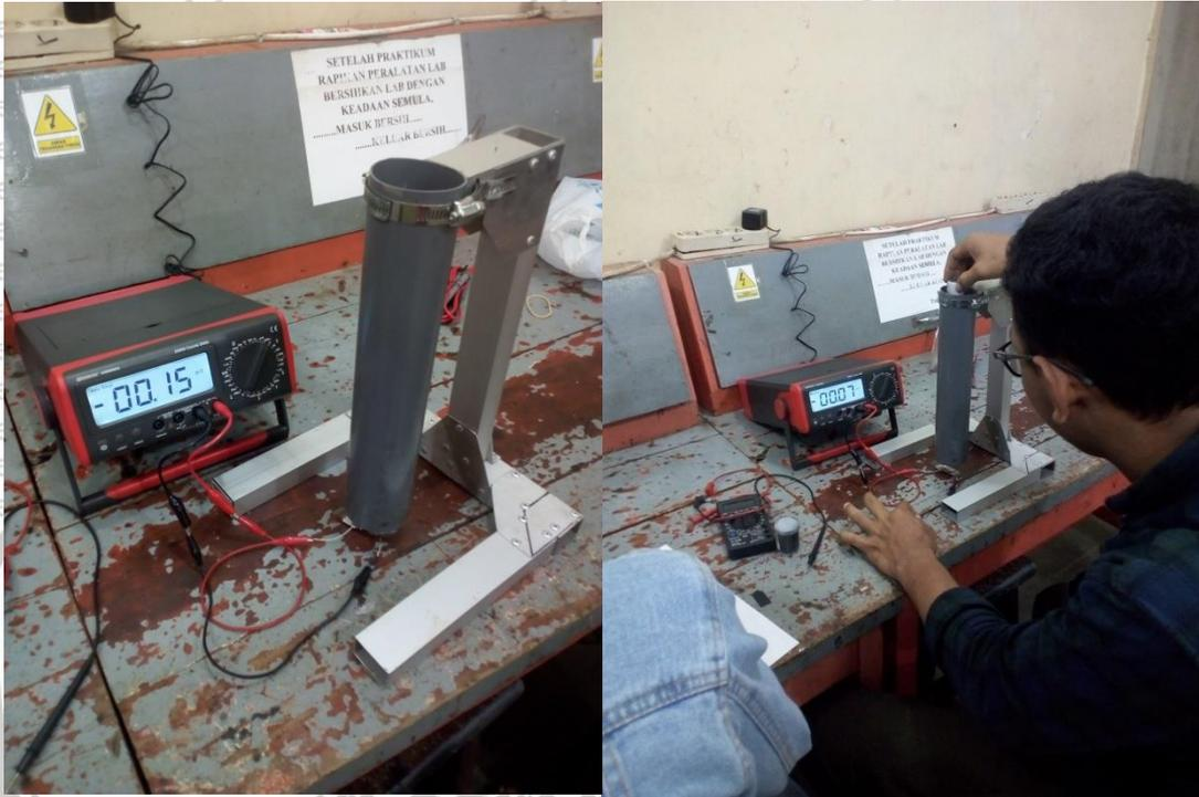
**Gambar 4.10** Pengukuran Respon Tegangan Piezoelektrik
