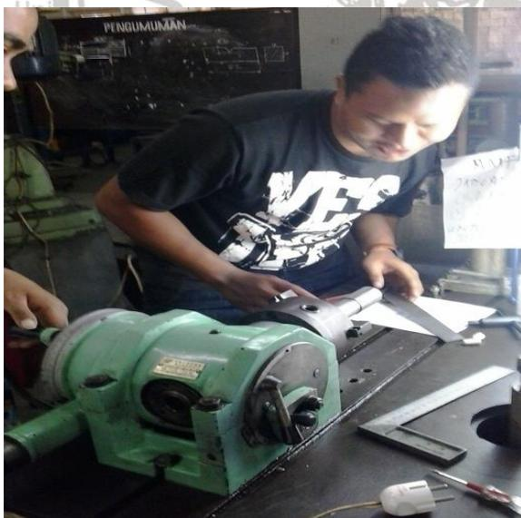
Gambar 4.7 Setting posisi spesimen pada
