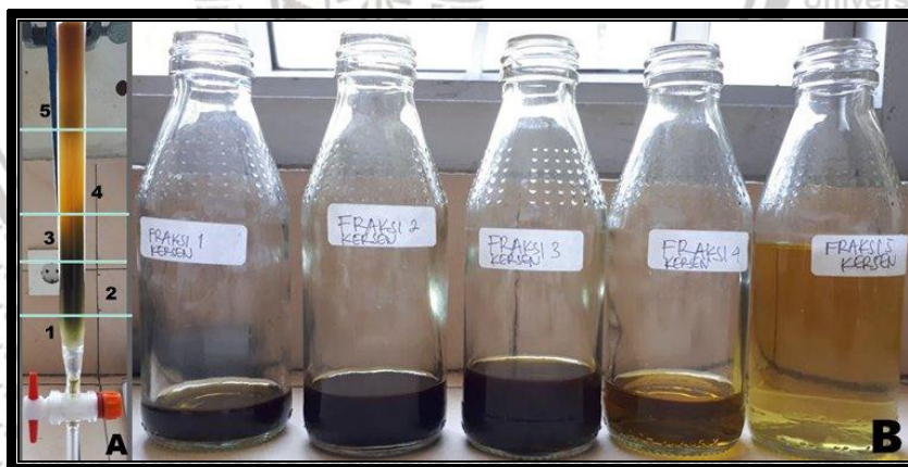
Gambar 8. Fraksinasi Kromatografi Kolom. (A) Proses Kromatografi Kolom; (B) Hasil Fraksi Kromatografi Kolom.
