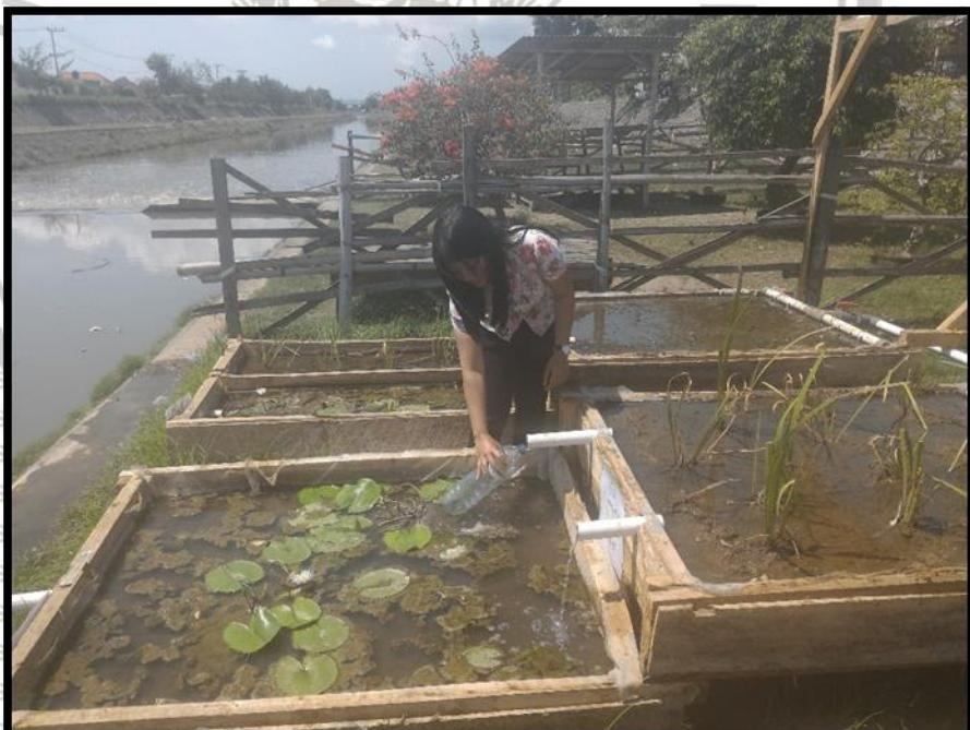
**Gambar 4.10. Pengambilan Sample pada Model Wetland 2 (Subsurface dengan Vegetasi Dlingo)**
