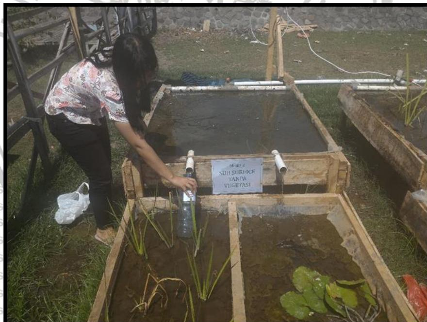
**Gambar 4.6. Pengambilan Sample pada Model Wetland 1 (Sub-surface tanpa Vegetasi)**
