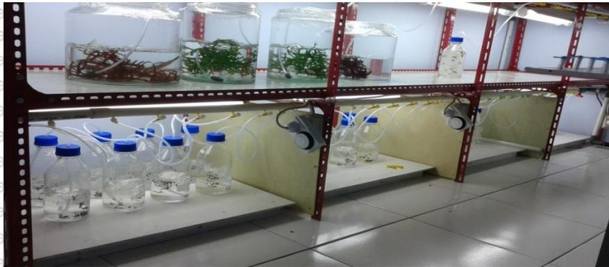
Pada tahap ini dilakukan kultur rumput laut *E. Cottonii* dengan menggunakan empat perlakuan fotoperiod, yaitu Perlakuan A (8 jam terang : 16 jam gelap), Perlakuan B (12 jam terang : 12 jam gelap), Perlakuan C (24 jam terang), Perlakuan D 16 jam terang : 8 jam gelap)
