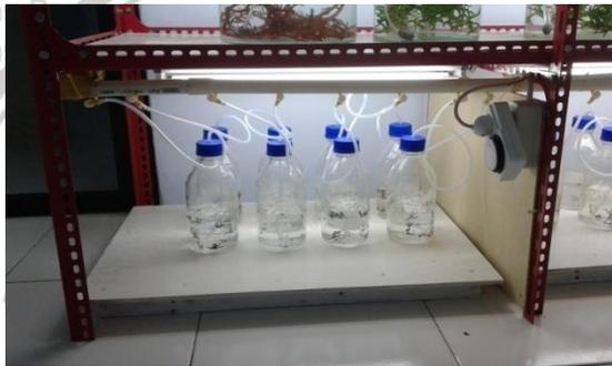
Pengaturan fotoperiod diatur dengan menggunakan timer yang diletakkan pada bagian samping
