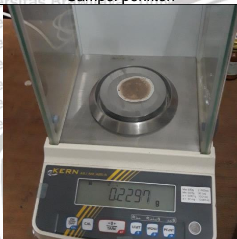
Penimbangan kertas saring setelah dilakukan penyaringan TSS
