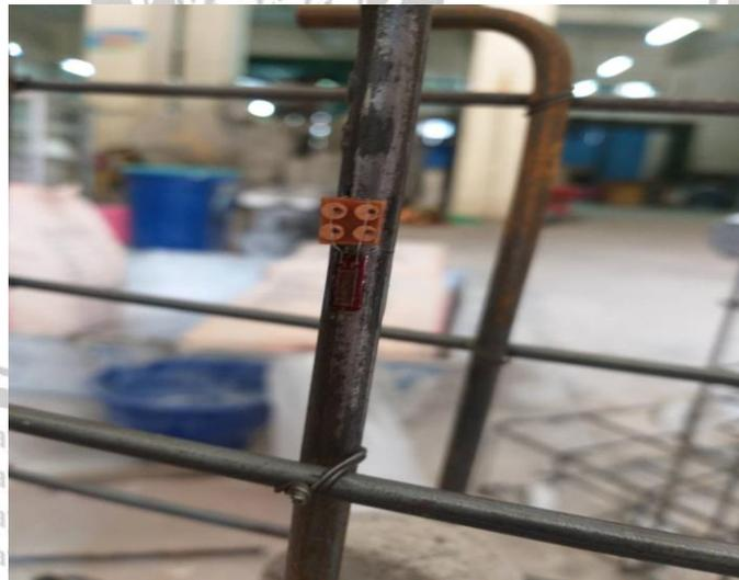
Gambar 4.13 Posisi Perletakan Strain Gauge Beton
