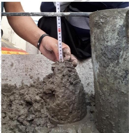
Gambar 4.2 Uji Slump Beton.
