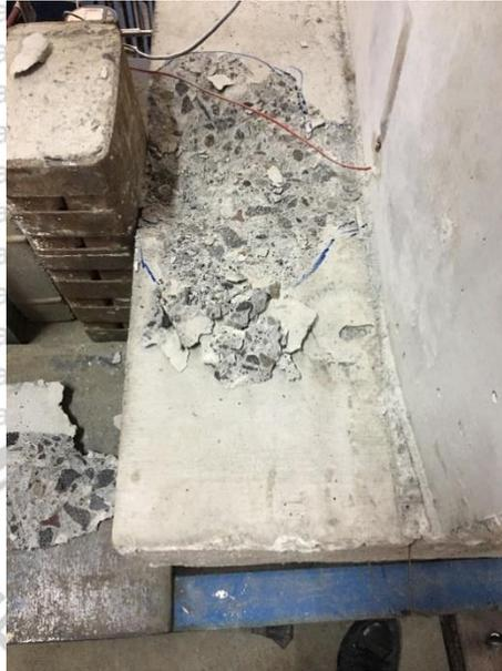
Gambar 4.9 retak yang terjadi pada bagian tumpuan benda uji
