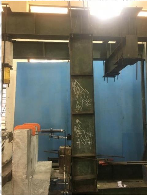
Gambar 4.7 Frame yang bengkok karena tidak mampu menahan gaya pada benda uji
