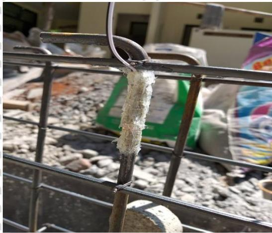
Gambar 4.12 Posisi Perletakan Strain Gauge pada Tulangan Baja Abutment
