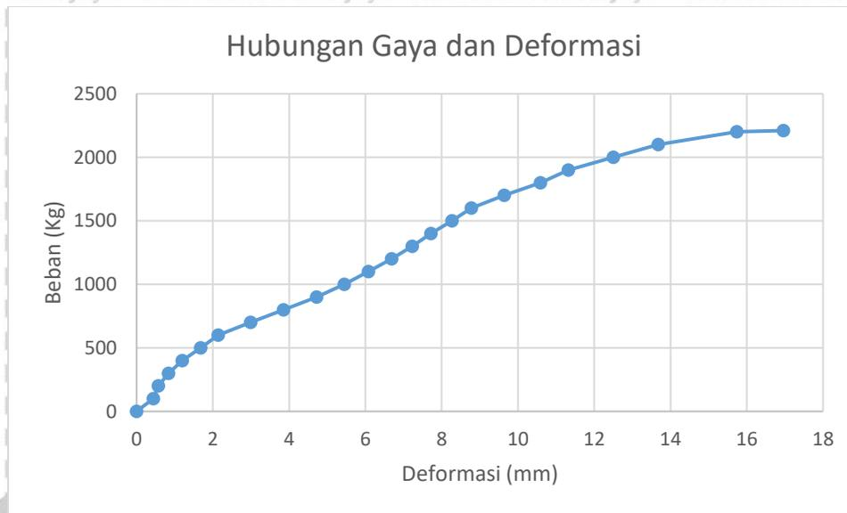
Gambar 4.5 grafik Hasil Pengujian Beban Lateral Benda Uji Abutment II
