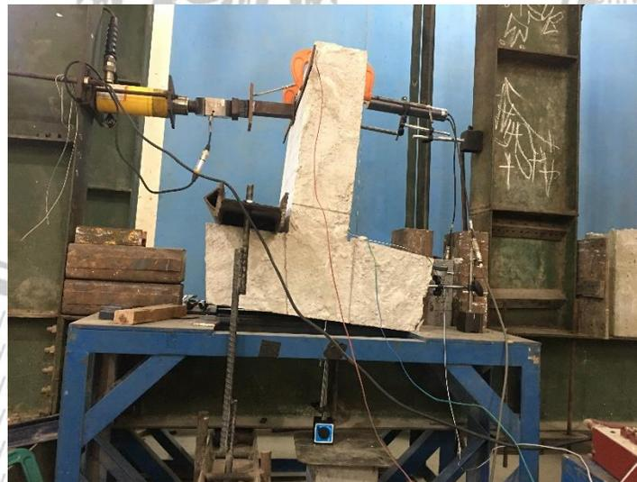
Gambar 4.8 benda uji dengan dimensi kurang sempurna yang terangkat akibat klem tidak mampu menahan gaya pada benda uji
