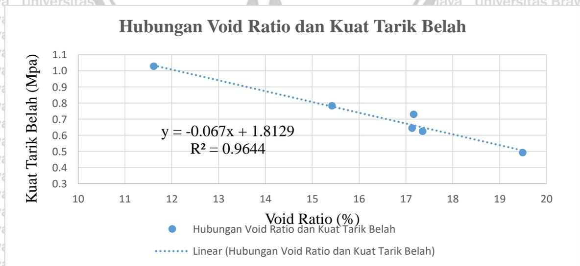
Gambar 4. 10 Hubungan kuat tarik belah beton dengan void ratio
