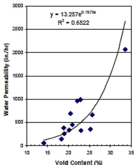
Gambar 2. 2 Hubungan void ratio dengan permeabilitas
