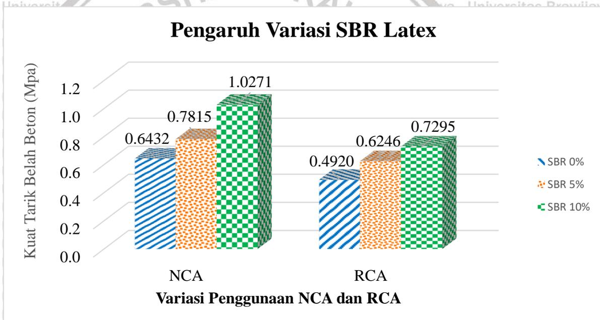
Gambar 4. 6 Grafik pengaruh variasi penambahan styrene butadiene rubber latex terhadap kuat tarik belah beton *porous*
