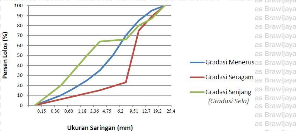
Gambar 2. 4 Grafik gradasi agregat
