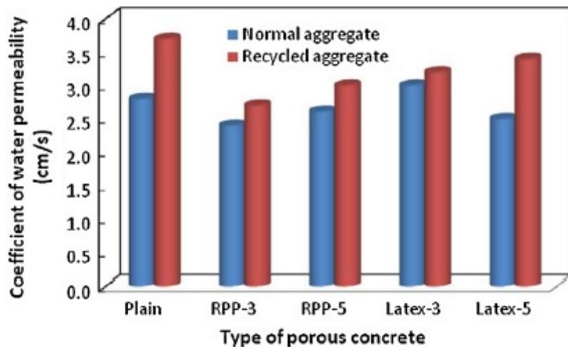
Gambar 2. 3 Hubungan laju permabilitas dengan beton porous
