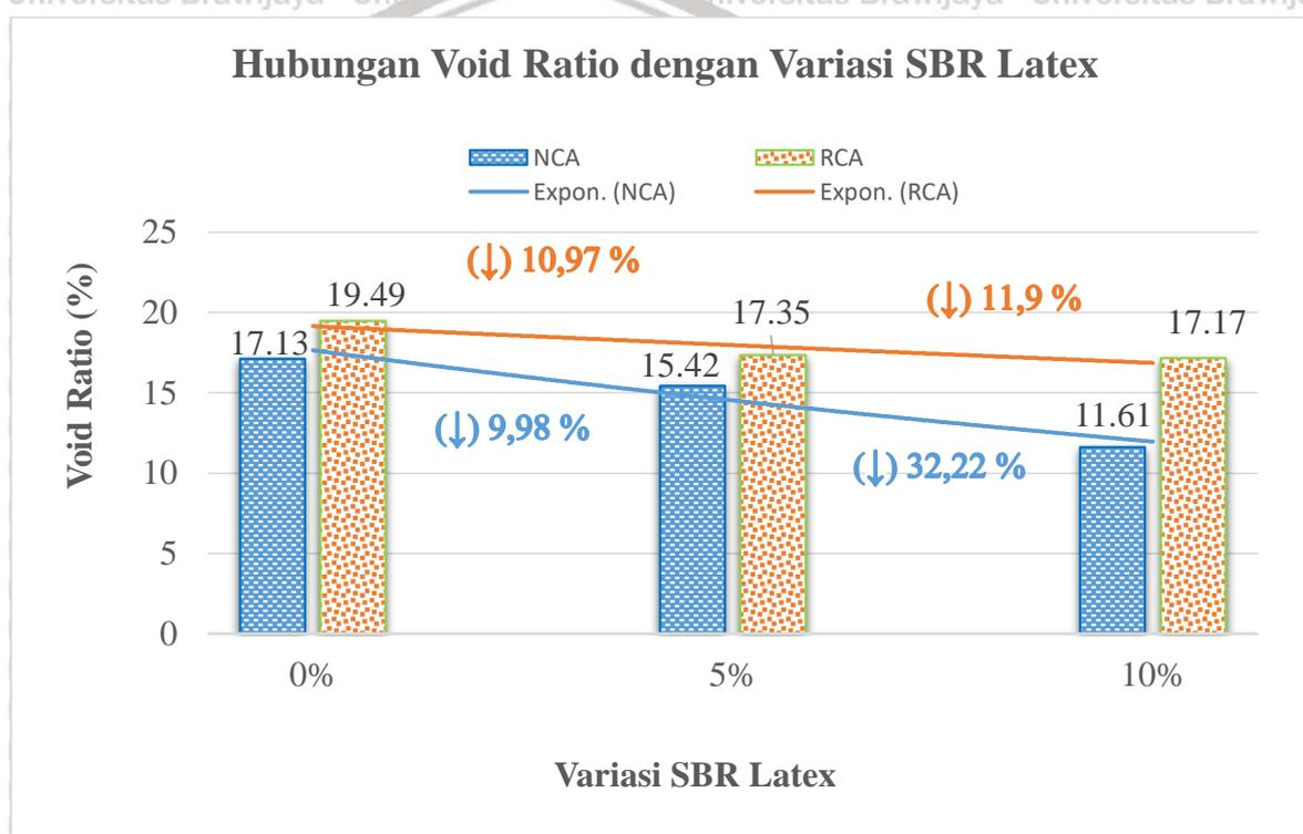
Gambar 4. 3 Hubungan void ratio dengan variasi SBR latex
