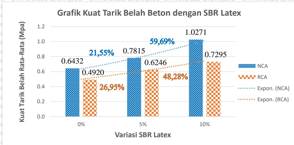
Gambar 4. 7 Grafik pengaruh penggunaan agregat kasar alami dan agregat kasar daur ulang pada kuat tarik belah beton porous
