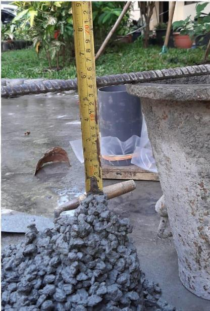
Gambar 4. 1 Pengukuran nilai slump beton segar
