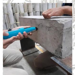
Gambar 8. Pengujian Kuat Tekan menggunakan Hammer Test
