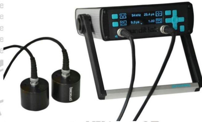
Gambar 3. 1 Alat UPV Proceq tipe PL-200
